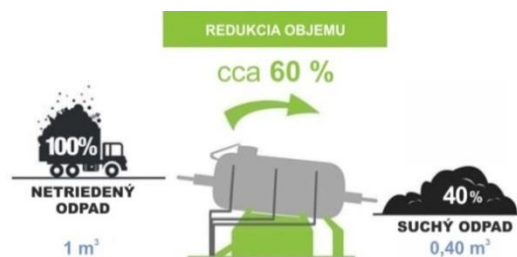
Obr. 25: Významná objemová redukcia odpadu
