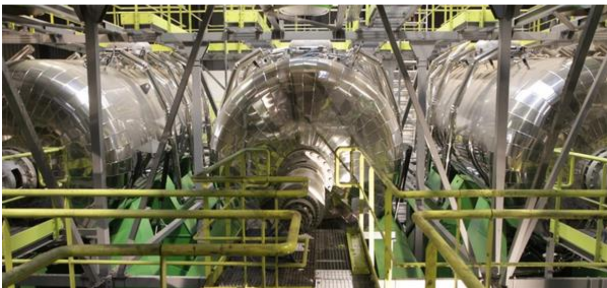
Obr. 22: Skupina parných autoklávov RotoSTERIL BEG7000 na obdobnej prevádzke
