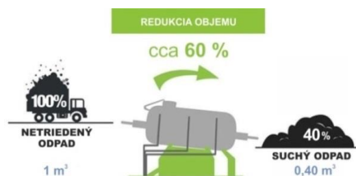
Obr. 120: Významná objemová redukcia odpadu
